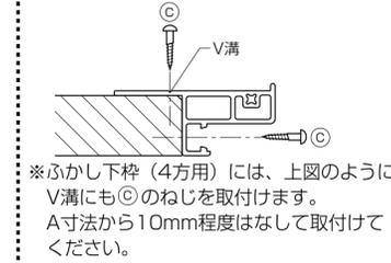
※ふかし下枠(4方用)には、上図のようにV溝にも◎のねじを取付けます。A寸法から10mm程度はなして取付けてください。
